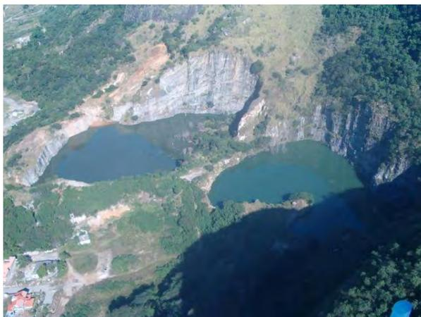
Figura 1.5.4.3.H – possibilidade de concepção de um reservatório de detenção utilizando uma pedra abandonada, controlando as contribuições da encosta para as áreas mais baixas da bacia, com a configuração de um parque no entorno.
