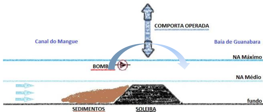
Figura HM 09.B – Representação esquemática do sistema de comporta operada para o exutório da bacia do Canal do Mangue.
