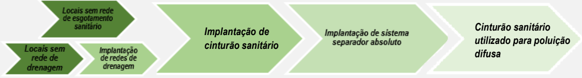
Figura A - Estágios propostos para o processo de captação e tratamento de esgotos urbanos
