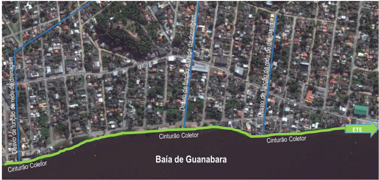
Figura BR 04.A - Figura esquemática do funcionamento do Cinturão Coletor para a Baía de Guanabara
