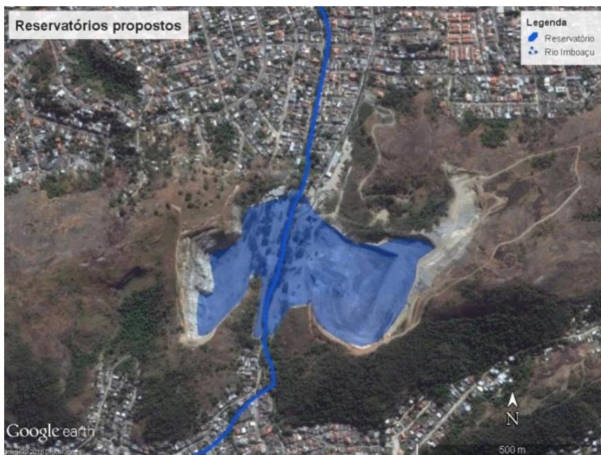
Figura HM 09.D – Detalhes das pedreiras Carioca Ltda. e Anhanguera S/A, sugeridas para implantação de reservatórios para controle de cheias
