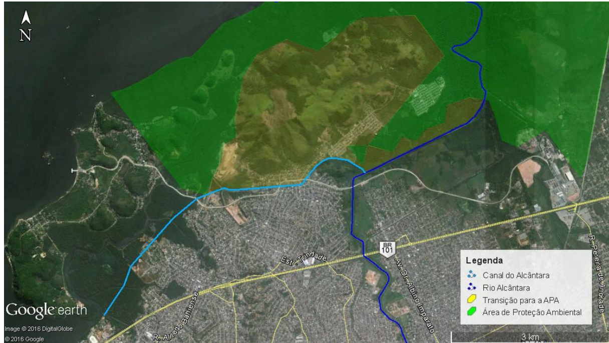
Figura EM 07.B – Canal Projetado para mitigação de cheias do Rio Alcântara e a APA proposta para Controle Ambiental e de Expansão Urbana.
